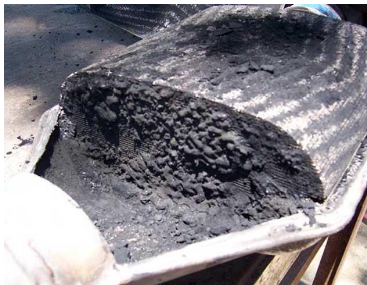
4. ábra: felnyitott könnyűjármű részecskeszűrője a lerakódott korommal
